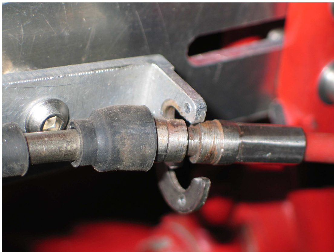
Photo 8 : Bride inox ouverte et dégagement de la gaine du câble. (nota 1)
