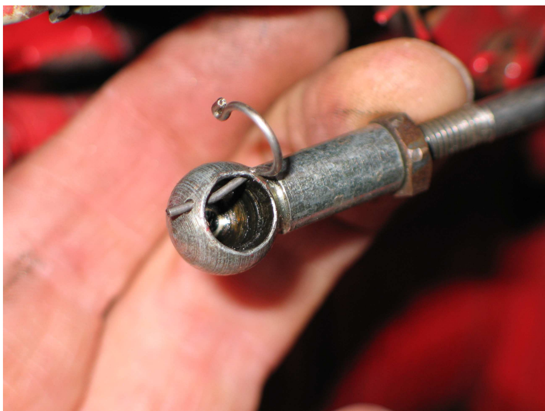
Photo 5 : vue de la goupille en place : elle empêche le déboitement de la rotule
